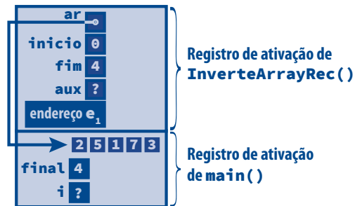
FIGURA 4-6: REGISTROS DE ATIVAÇÃO DE UMA FUNÇÃO COM RECURSÃO DE CAUDA 1
